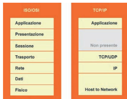
Fig. 1: Il modello TCP/IP a confronto con l'architettura ISO/OSI
